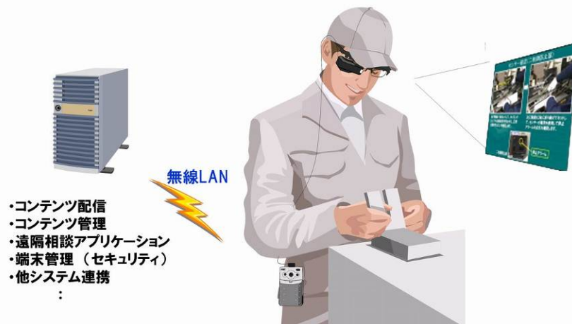
図表 43 メガネ型ヘッドマウントディスプレイ（HMD）とウェアラブルコンピュータで構成される業務端末「Tele Scouter(テレスカウター)」
