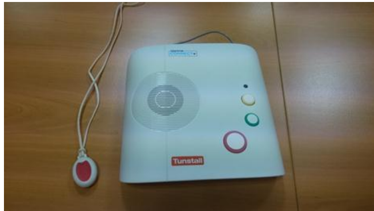
図表 135 利用者宅に設置される緊急通報装置
